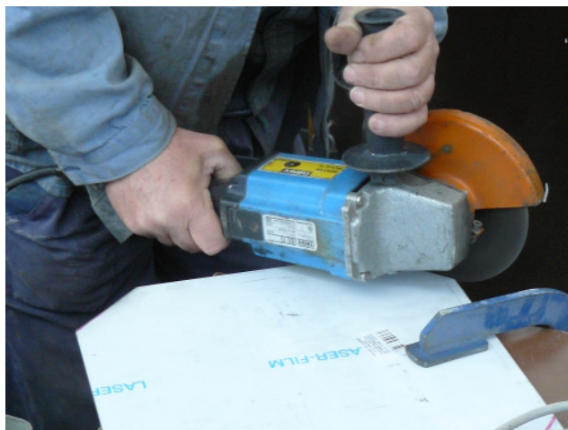
Obr. 32 Úprava rohů bezpečnostního plechu
