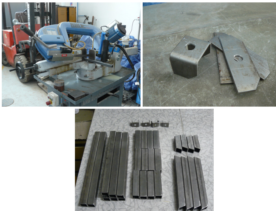
Obr. 40 Výroba přípravku pro test deformačního členu - příprava
