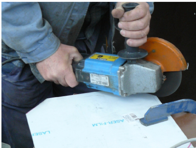
Obr. 32 Úprava rohů bezpečnostního plechu
