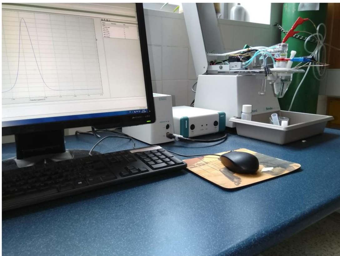
Obrázek 7: Přístroj 663 VA Stand od firmy Metrohm a Autolab potentiostat od firmy Metrohm
