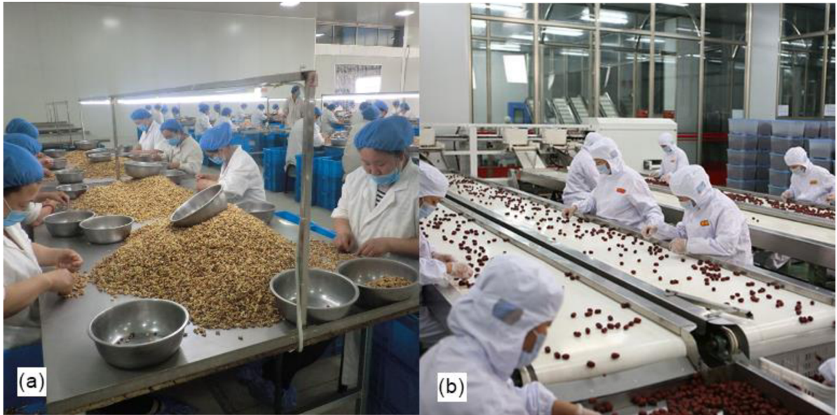
Obr. 1-1 Ručné (a) a poloautomatizované (b) triedenie vlašských orechov [1]
