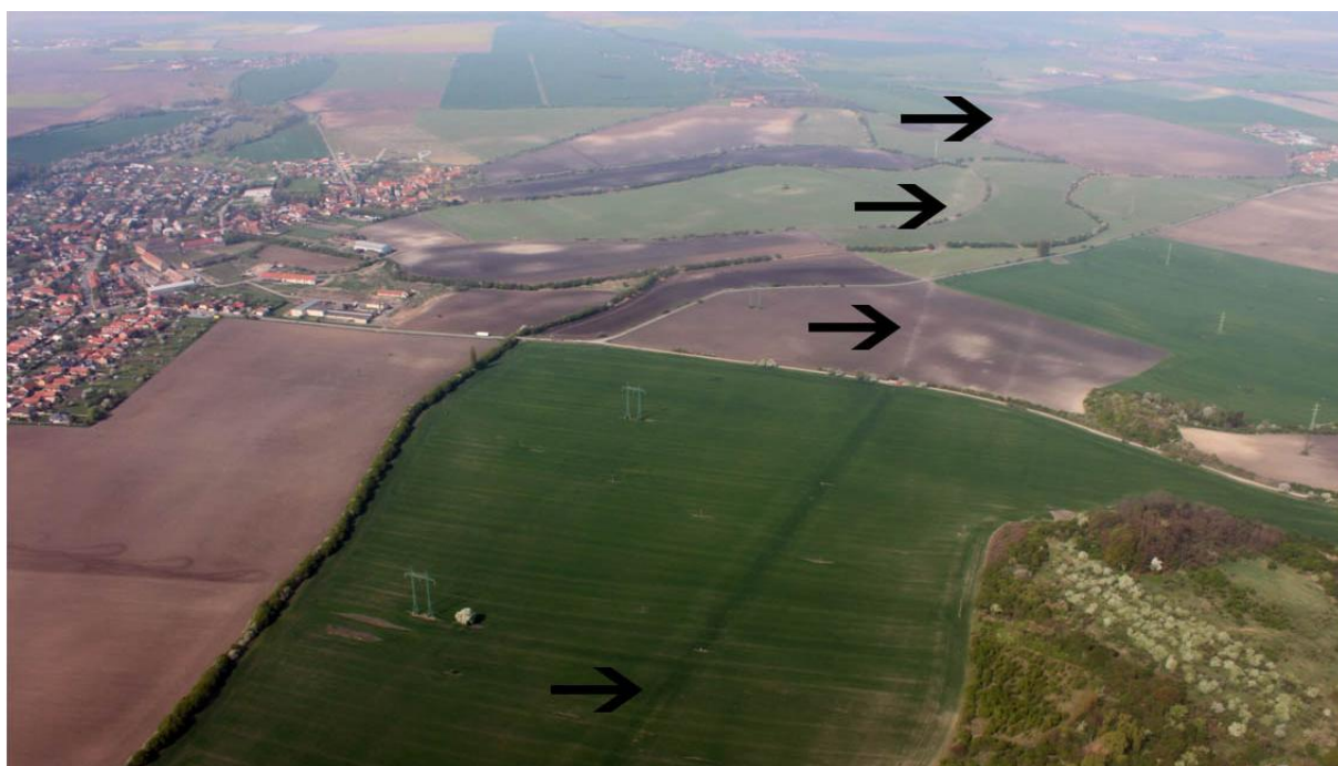
Foto č. 80: Produktovod DN300 procházející katastrem Kounic zobrazený díky půdním a vegetačním příznakům
