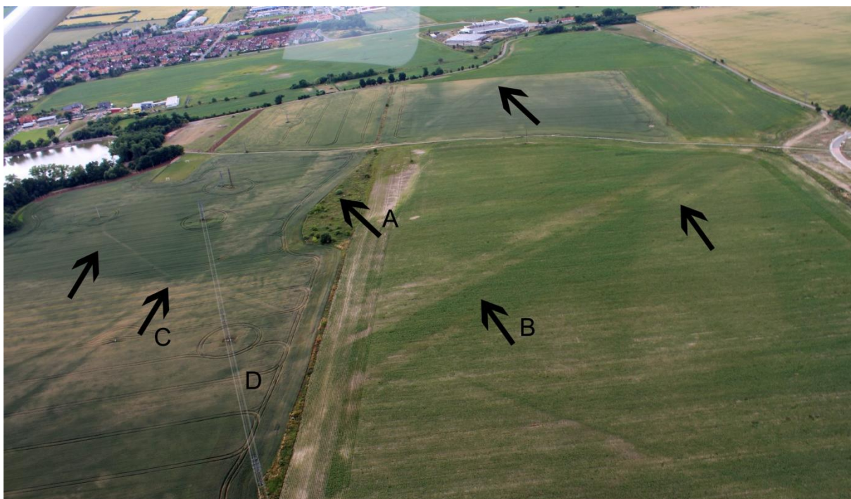
Foto č. 29: Propis informací pomocí vegetačních příznaků A a B dvě větve velkokapacitního přivaděče, který rozvádí vodu z vodojemu Vestec dvěma rameny do Prahy, C zaniklá polní cesta ke statku Drazdy, D stávající nadzemní elektrické vedení (27.6.2014)
