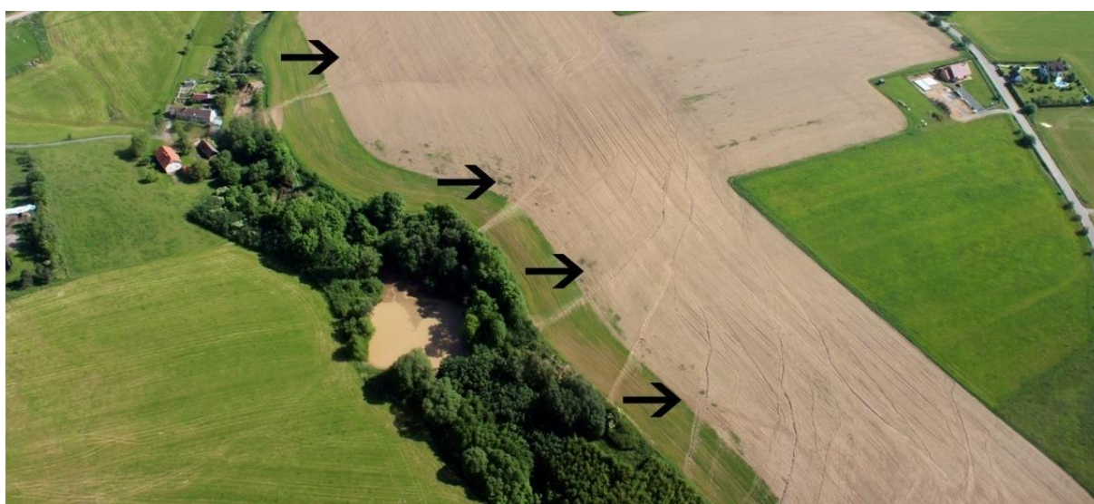
Foto č. 49: Vícečetné erozní rýhy, které ukazují, že pás zatravnění není dostatečně široký, aby byl schopen zadržet dešťové vody tekoucí z kopce nad porostem. Zde se rýhy neprojevují, jelikož travní drn má větší erozní odolnost
