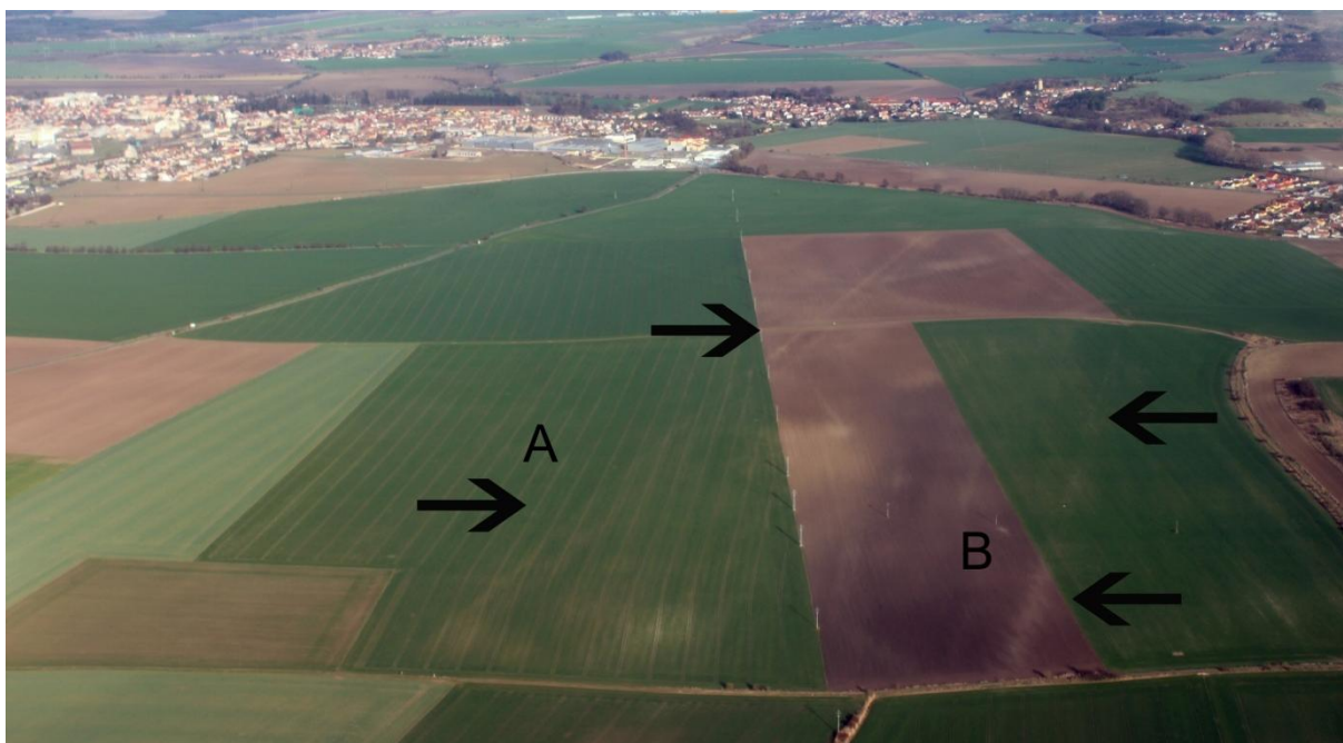
Foto č. 79: Podzemní vedení na katastru obce Radim, A – VVTL plynovod, B – VTL plynovod, propsáno díky kombinaci půdních a vegetačních příznaků
