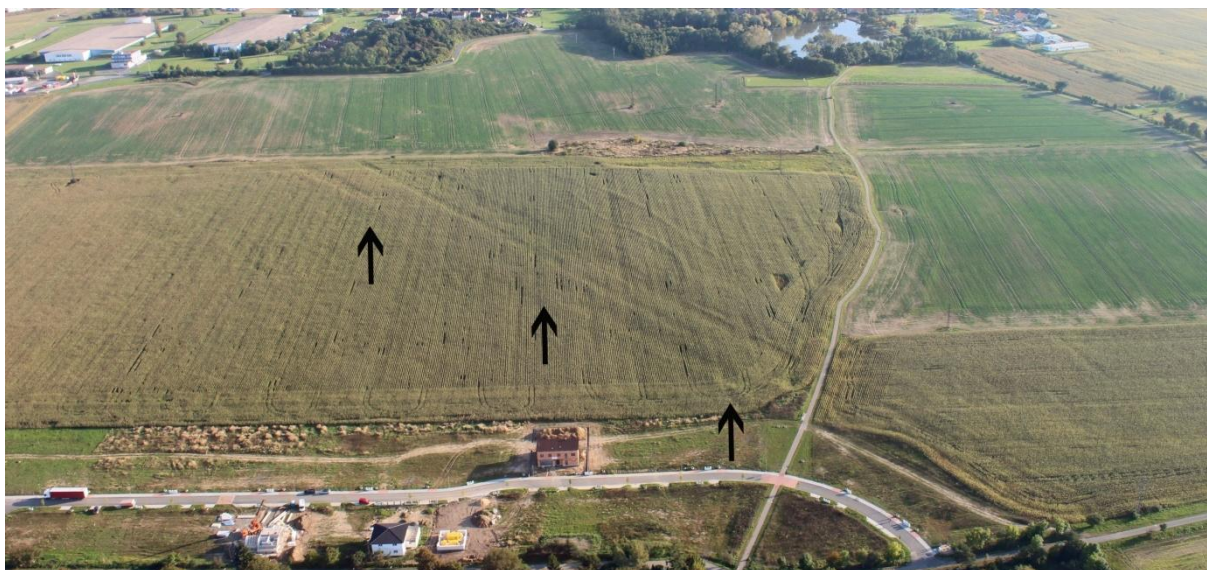
Foto č. 81: Velkokapacitní přivaděč vody z Želivky do Prahy, lokalita Vestec u Prahy, projev na kukuřici (konec září 2014)
