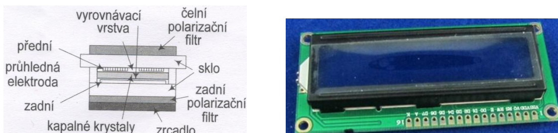
Obrázek 2.10: LCD displej — základní popis (vlevo) a jeho fyzická realizace v podobě LCD modulu (vpravo) [22].
