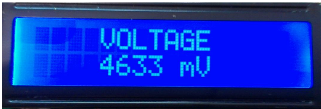
Obrázek 5.4: Následné zjištění napájecího napájení na akumulátoru.
