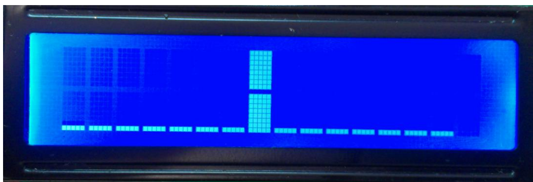
Obrázek 5.5: Testování spektra při kmitočtu f = 5\text{kHz} .
