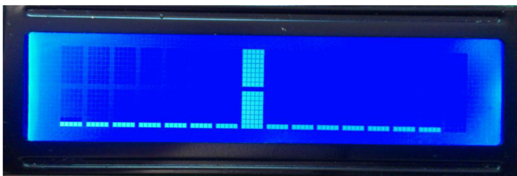
Obrázek 5.5: Testování spektra při kmitočtu f = 5\text{kHz} .
