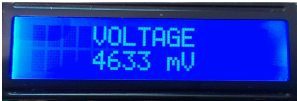
Obrázek 5.4: Následné zjištění napájecího napájení na akumulátoru.
