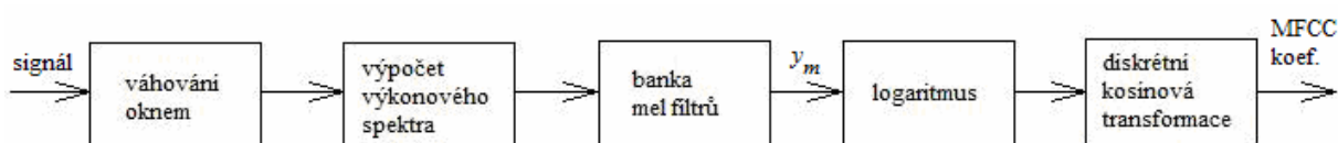
Obr. 4.18 Postup výpočtu MFCC koeficientů
