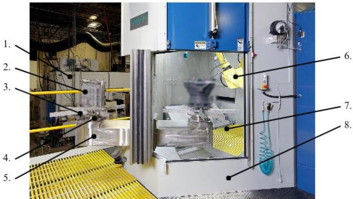
Obr. 16) Usporiadanie robotickej bunky pre čistenie odliatkov vysokotlakovým vodným lúčom [42]
