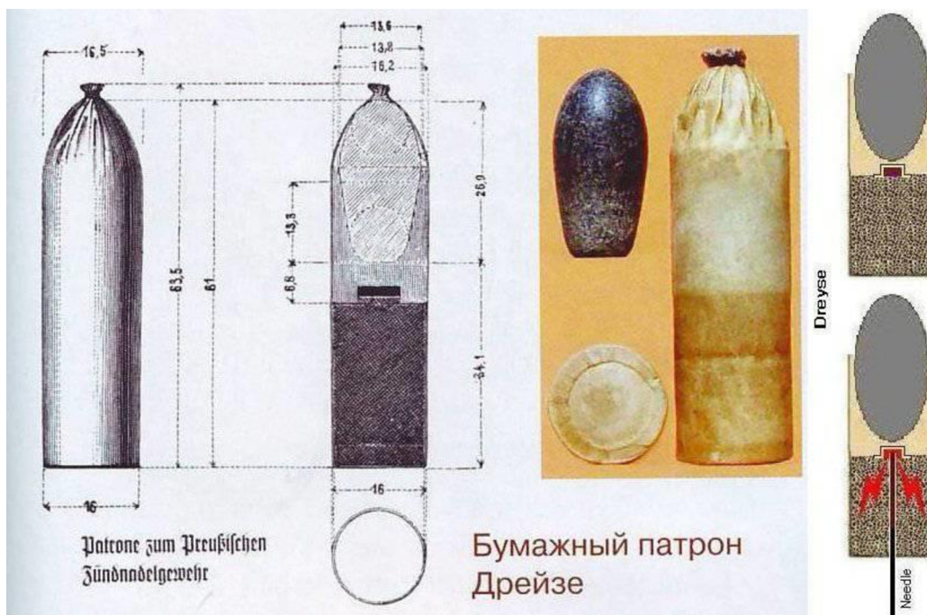
Obr. 13 Schéma náboje do Dreyseho jehlovky, dostupné z: https://en.topwar.ru/58879-igolchatyy-revolver-franca-dreyze.html
