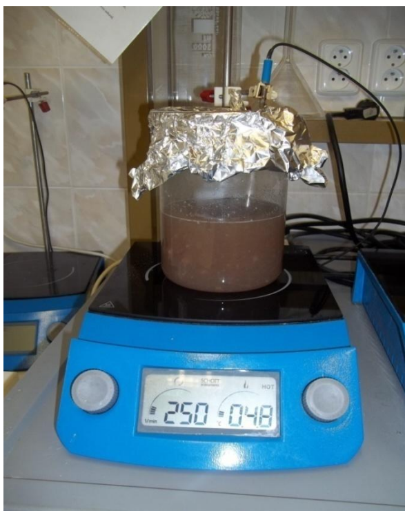
Obr. č. 10: Vzorky masa se tráví pomocí magnetické míchačky
