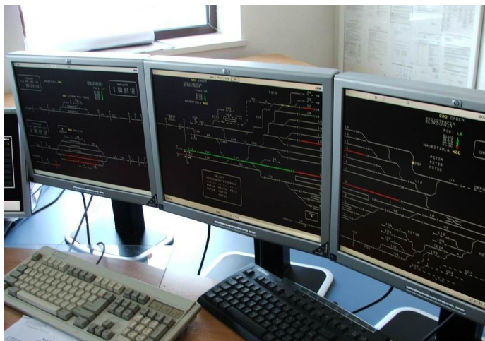
Obrázek 2.3: Ovládanie SZZ (Bombardier EbiLock 950, Žst. Čadca), zdroj: www.vlaky.net
