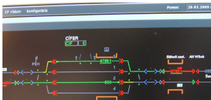
Obrázek 5.3: Ovládací počítač stavadla s prenosom čísel (SIMIS-W, DOT Trnava)
