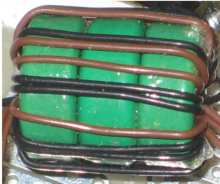
Obr. 4.2: Transformátorek v budicím obvodu měniče
