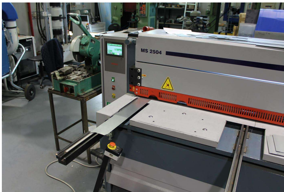
Obr. 3.4: Nůžky MS 2504 s plátem na stříh vzorků
