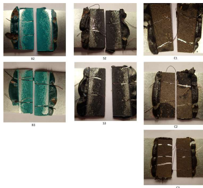
Obr. 3.10 Ukázka lomů vzorků po zkoušce pevnosti ve smyku při zatěžování tahem
