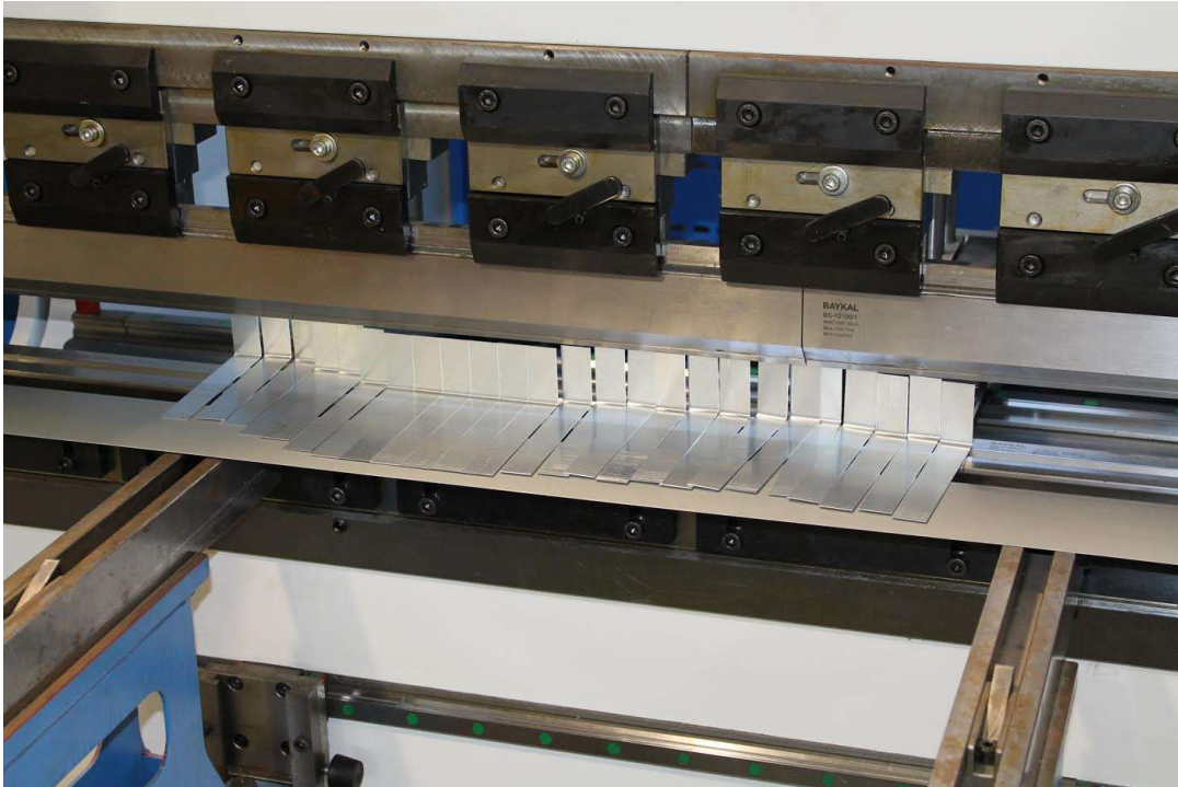
Obr. 3.7: Ohraňovací lis Baykal APHS 2104x60 a zohýbané vzorky pro zkoušky odlupem
