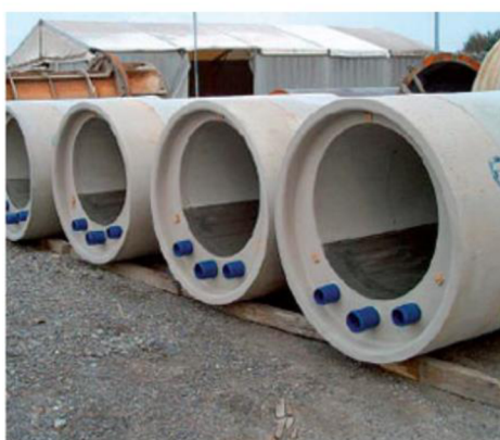
Obr. 2.18 Integrovaný výměník tepla ve stěně betonové kanalizační trubky [29]
