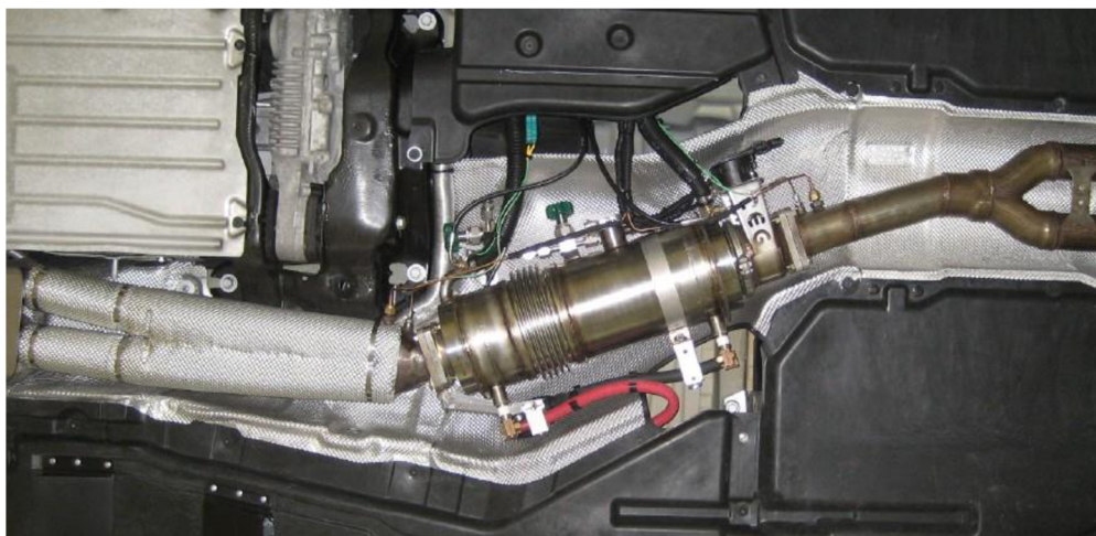
Obrázek 13 Fotografie umístění termočlánků do výfukového ústrojí [20]
