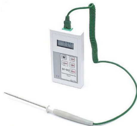
Obrázek 31 Laboratorní termočlánekový teploměr [23]
