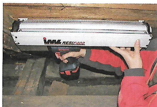
Obr.23 Přístroj RESIF400 firmy IML (Kloiber, Drdácký 2015).
