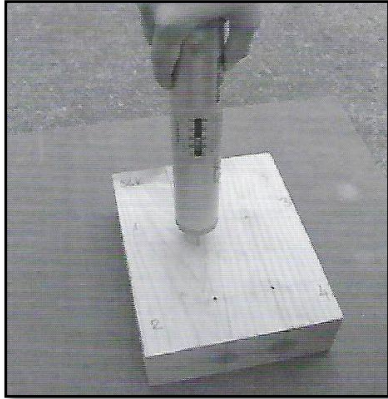
Obr.16 Ukázka odporového zarážení trnu pomocí přístroje Pilodyn.
