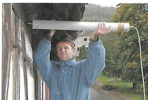
Obr.22 Přístroj 2450-S firmy Rinntech (Kloiber, Drdácký 2015).
