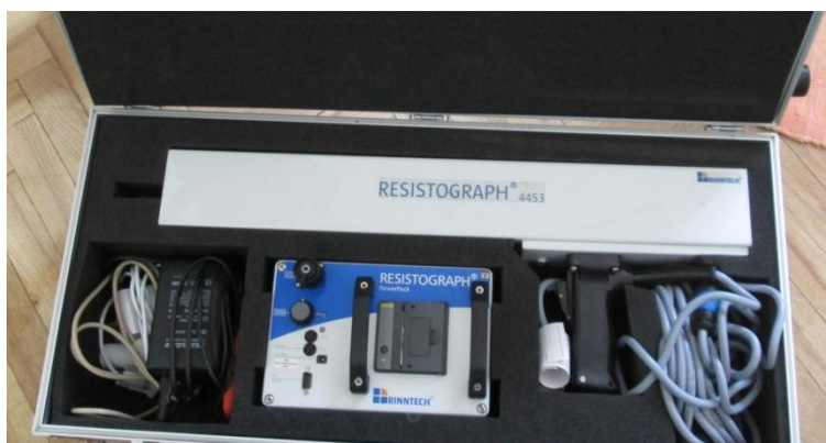
Obr.24 Kompletní vybavení přístroje Resistograph 4453-S firmy Rinntech (vlastní).
