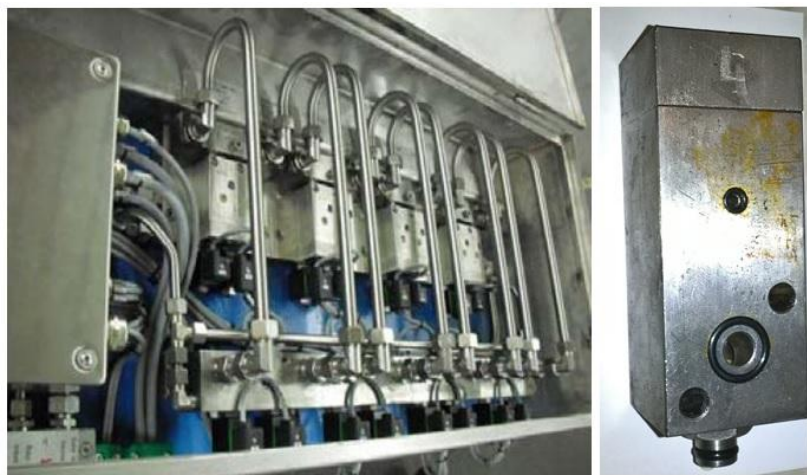
Obr. 18: vlevo přívod maziva do náradí, vpravo ventil
