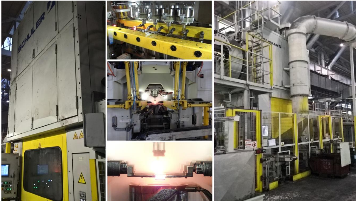
Obr. 58: Kovací klikový lis PK 1600 Schuler
