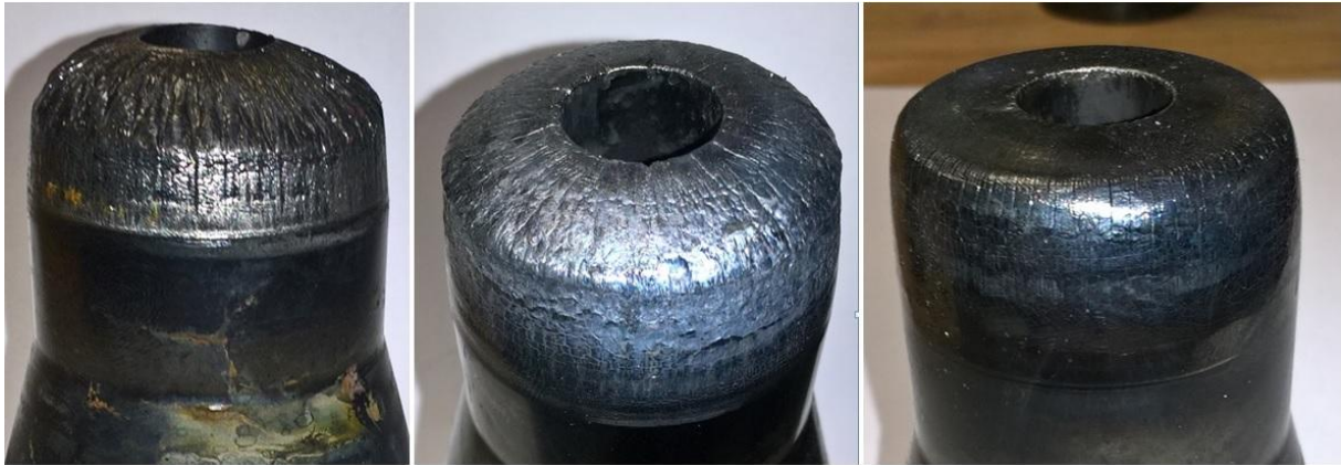
Obr. 52: Vlevo pēchovací trn vrchní, uprostřed pŕedkovací trn vrchní, vpravo dokonēovací trn vrchní po odkování 10 000ks vŕkovkŕ za vŕrobní dāvku
