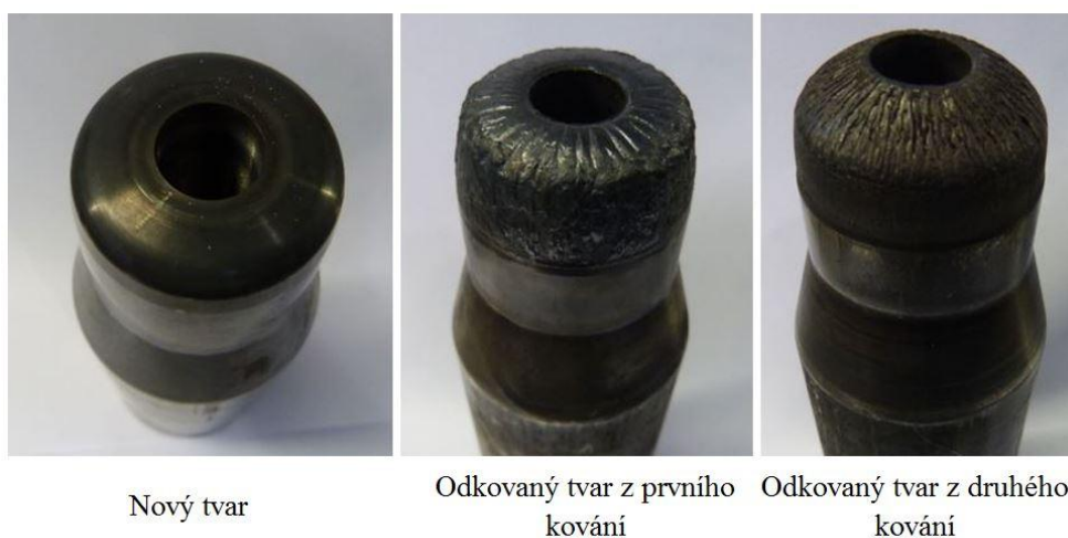
Obr. 42: Míra deformace tvarové části trnů po odkování z prvních dvou zkoušek
