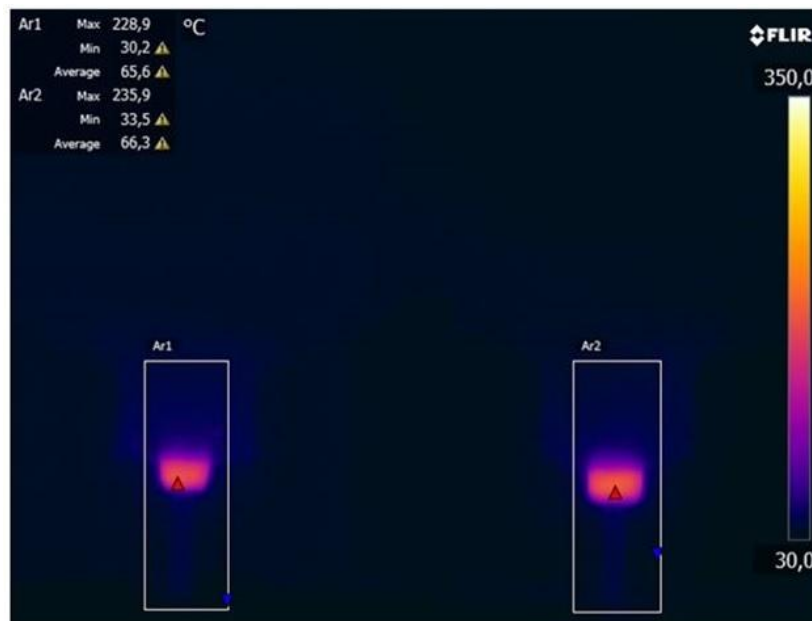
Obr. 57: Teplota trnů vrchních po ochlazením proudem mazadla
