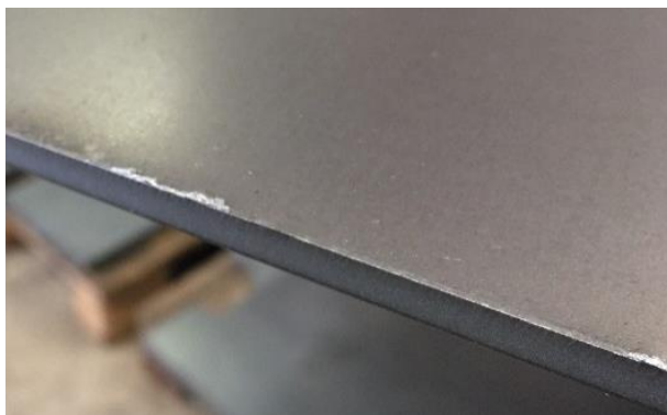
Obr. 2.4 Vzhled řezné hrany po řezání vodním paprskem.
