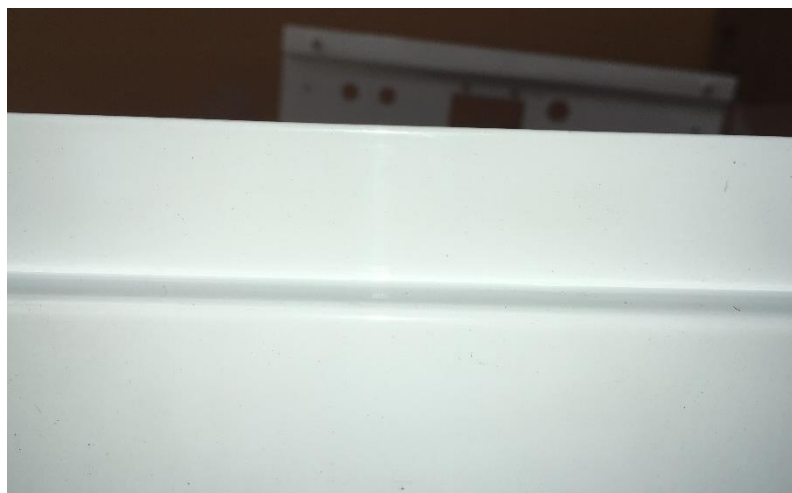
Obr. 2.16 Vzhled plechu zad kotle po práškovém lakování.
