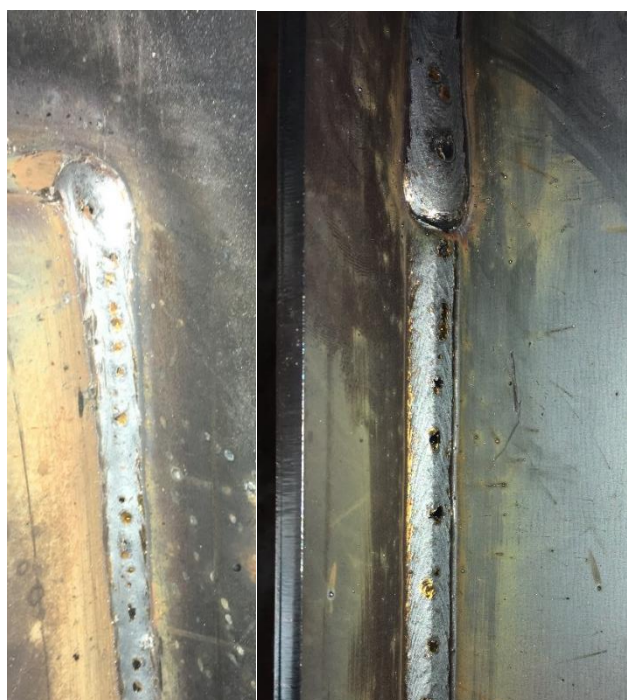
Obr. 4.7 Porovnání svarů (vlevo ruční, vpravo robotizované).
