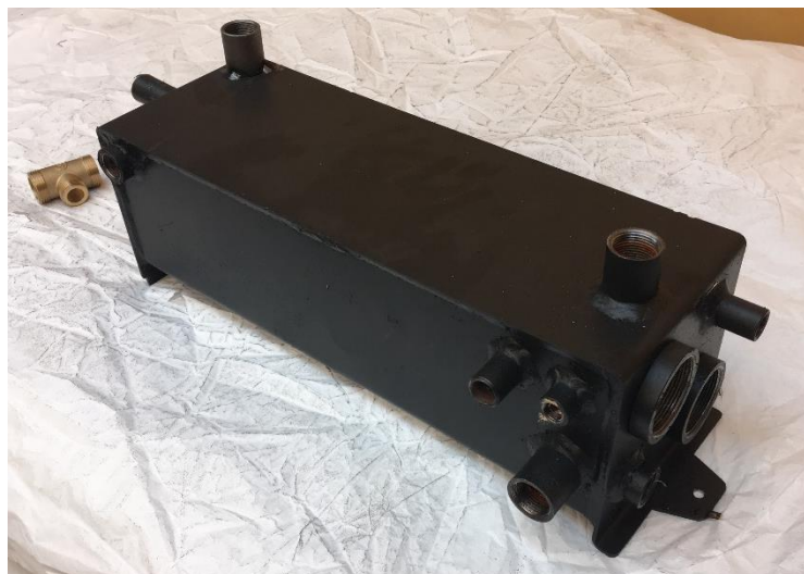
Obr. 2.17 Vzhled kotlového tělesa po nanesení barvy.
