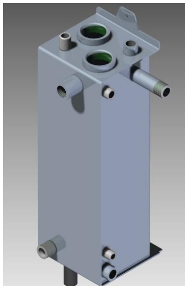
Obr. 3.9 Svařenec kotlového tělesa kompletní.
