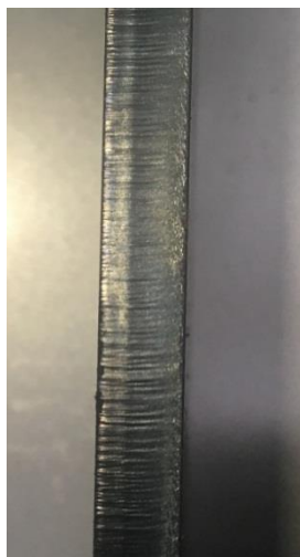
Obr. 2.3 Vzhled řezné hrany po řezání laserem.
