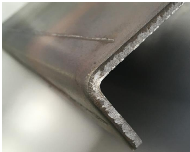
Obr. 2.13 Vzhled ohybu po ohýbání na ohraňovacím lisu AMADA.
