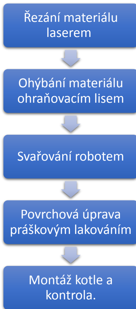
Obr. 2.19 Navrhovaná posloupnost výroby elektrokotle JE 6/12.
