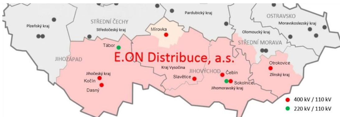
Obr. 14 – Distribuční soustava E.ON Distribuce a uzlové rozvodny (upraveno z [4])
