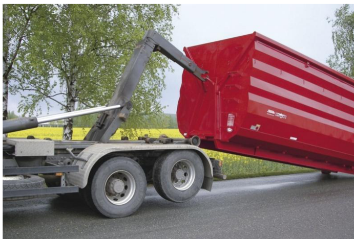
Obr. 2.3: Otevřený odvalovací kontejner [25]
