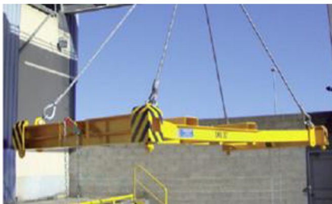
Obr. 4.3: Manuálně ovládaný fixní spreader [18]
