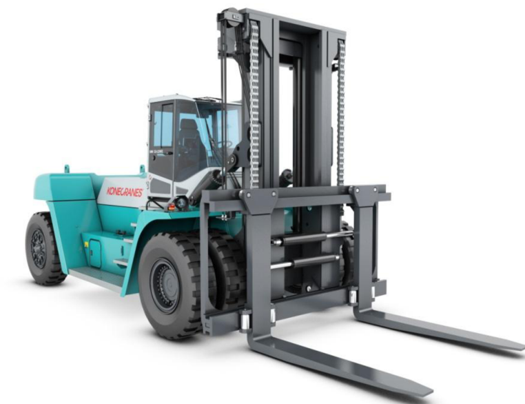
Obr. 4.8: Překladač vybavený lyžinami [14]
