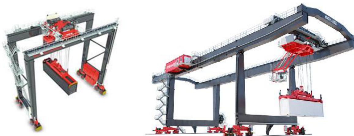
Obr. 3.3: vlevo - RTG jeřáb; vpravo RMG jeřáb [14]
