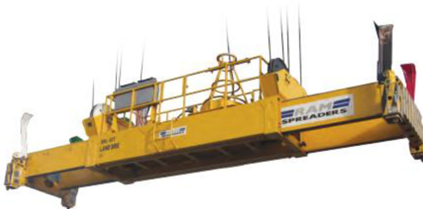
Obr. 4.4: Single-lift teleskopický spreader [20]
