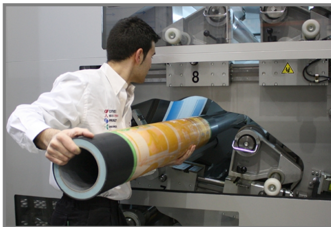
Obr. 1-9 Výměna sleeveů s nalepenou flexotiskovou formou [13]
