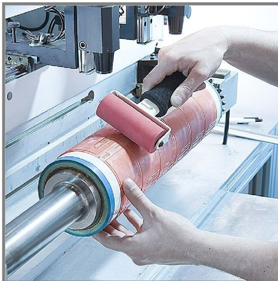
Obr. 1-13 Montáž štočku na návlek pomocí oboustranné lepicí pásky [20]
