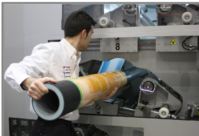
Obr. 1-9 Výměna sleeveů s nalepenou flexotiskovou formou [13]
