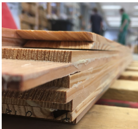
Obr. 14. Nařezané a slepené lamely
