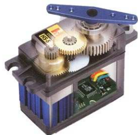
Obr. 3.1: Řez serva od firmy Hitec [8].
