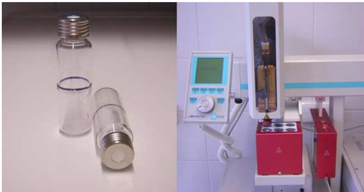
Obr. 3.2: Vzorovací vialky (vlevo), automatický dávkovač Combi PAL (vpravo)
