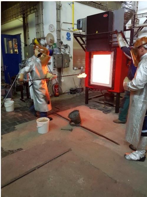
Obr. 49 Vytahování formy z žíhací pece
