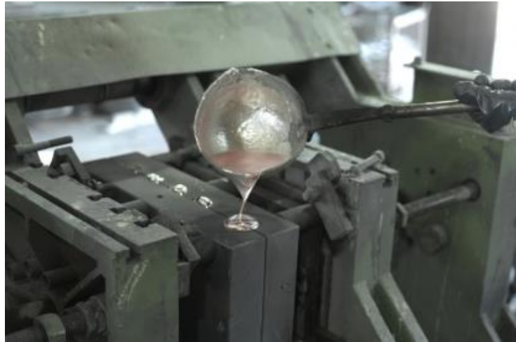
Obr. 6 Kokilové lití – trvalá forma [24]
