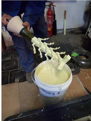
Obr. 44 Namáčení stromečku v zirkonové břechce
