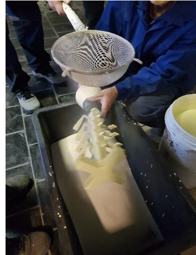
Obr. 45 Posypávání zirkonovým písekem
