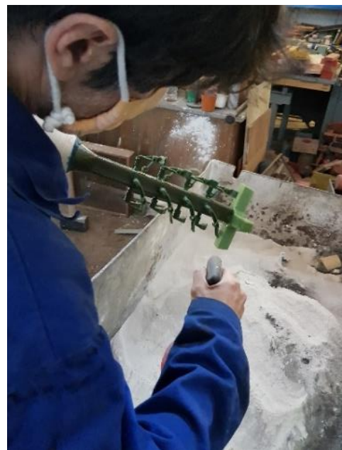
Obr. 42 Odmašťování pomocí lihu
