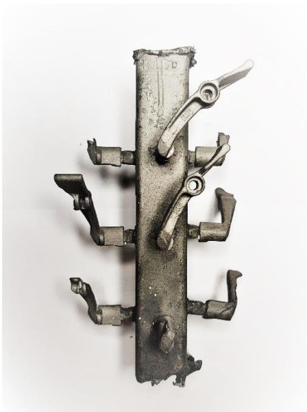
Obr. 52 Surový odlitek po otryskání
