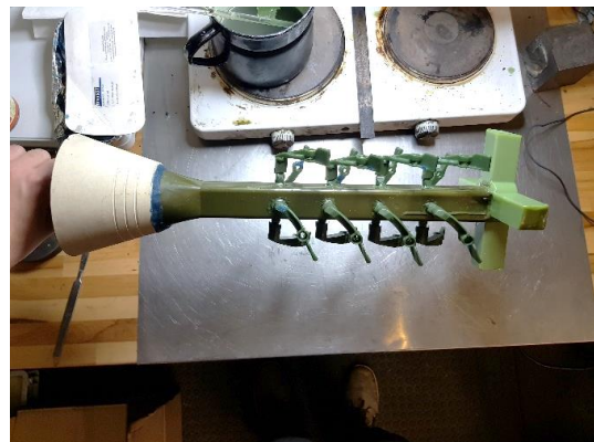
Obr. 41 Modely nalepené na stromečku
