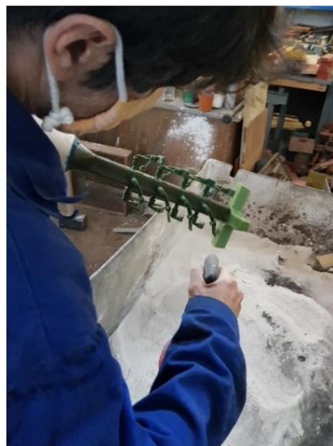
Obr. 42 Odmašťování pomocí lihu
