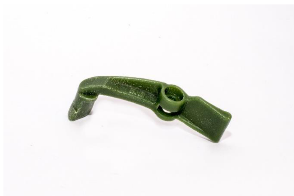
Obr. 39 Voskový model připravený k dalšímu použití
