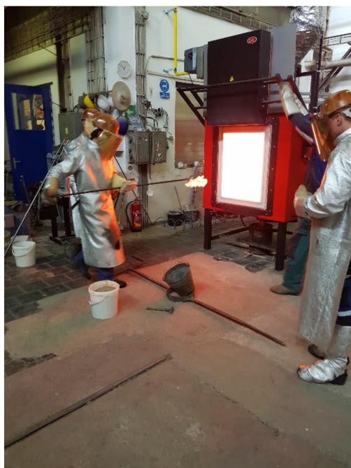
Obr. 49 Vytahování formy z žíhací pece
