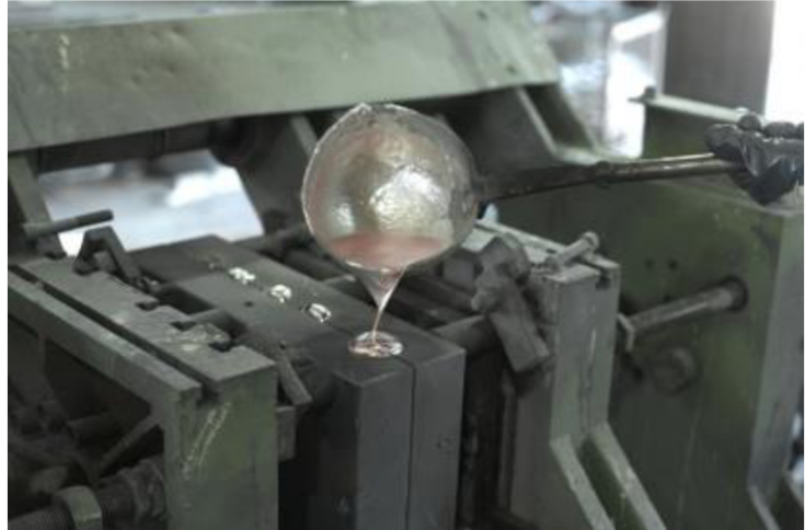
Obr. 6 Kokilové lití – trvalá forma [24]
