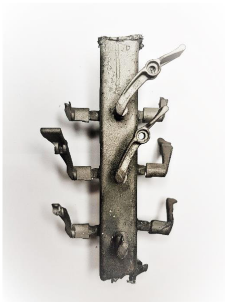
Obr. 52 Surový odlitek po otryskání
