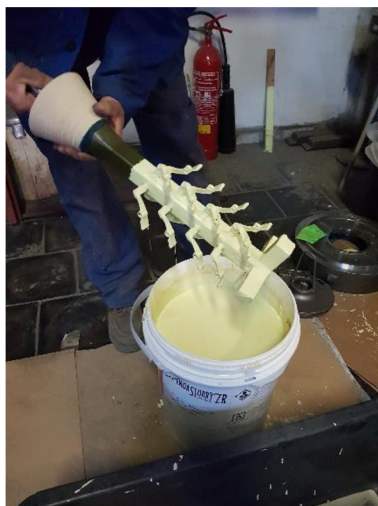
Obr. 44 Namáčení stromečku v zirkonové břechce
