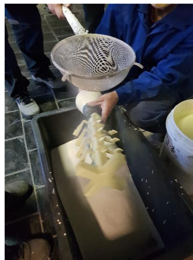
Obr. 45 Posypávání zirkonovým písekem
