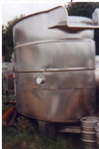
Obr. 6 Otevřená kvasná kád' pro svrchní kvašení
