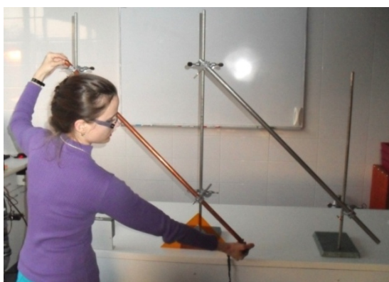
Obr. 20 Měření doby pádu magnetů měděnou a hliníkovou trubkou svírající úhel o velikosti 45^\circ se zemí.
