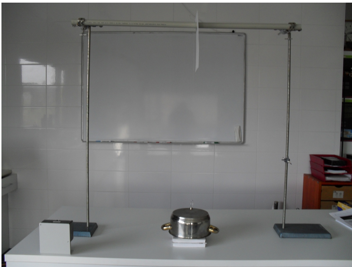
Obr. 30 Aparatura pro měření počtu kyvů do zastavení.
