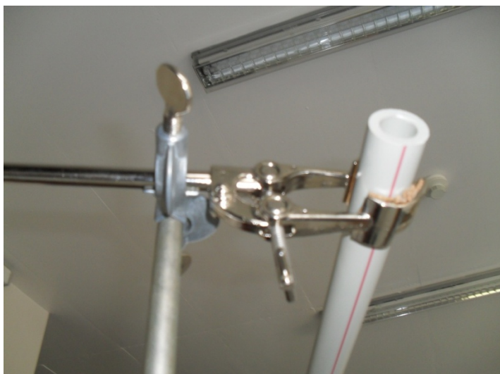
Obr. 32 Způsob upevnění plastové trubky k laboratornímu stojanu pomocí laboratorních držáků.
