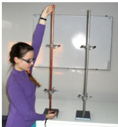
Obr. 19 Měření doby pádu magnetů měděnou a hliníkovou trubkou kolmou k zemi.
