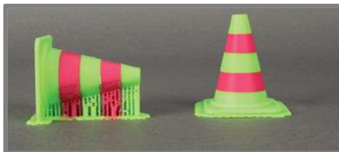
Obr. 3 Ukázka podpurné konstrukce [6]
