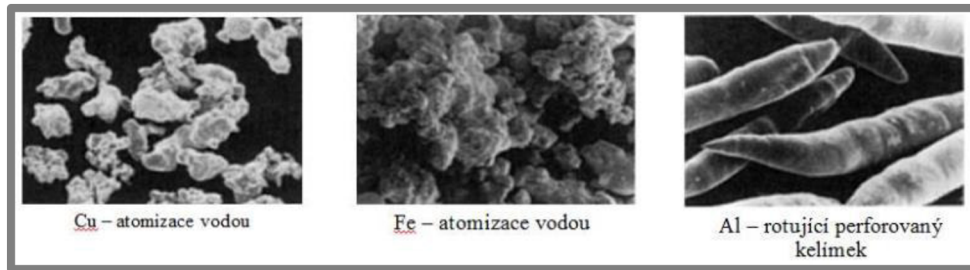
Obr. 17 Struktura částic po atomizaci vodou nebo atomizaci rotací [29]
