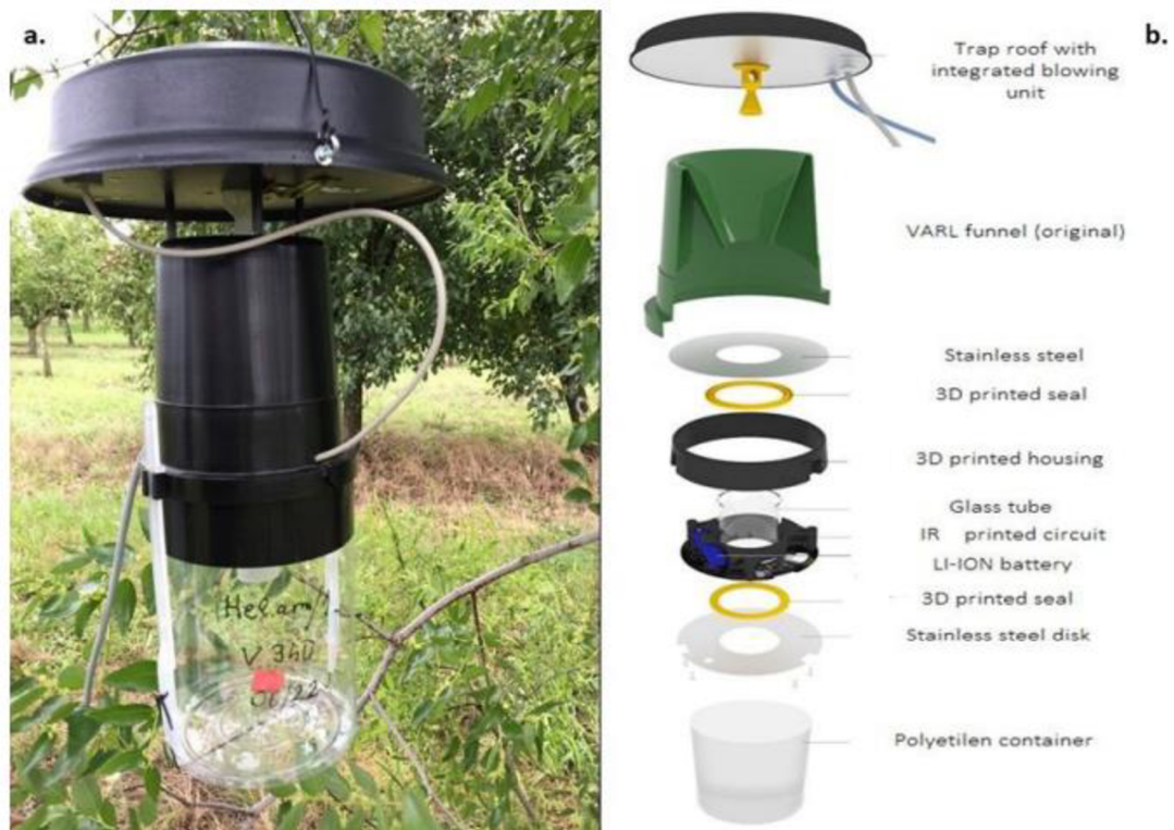
Příloha č. 1: Testovaný feromonový lapač ZooLog VARL, a – vlastní lapač na zájmovém území, b – jednotlivé součásti lapače s popisky (Flórian a kol., 2023)
