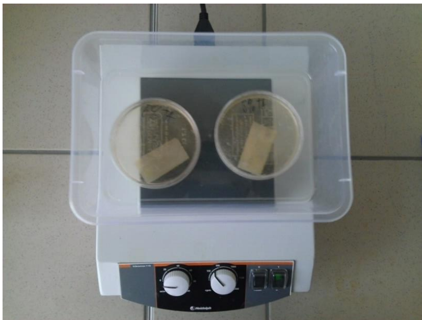
Obrázek 24: Třepačka se vzorky při probíhající imobilizaci kyseliny tříslové
