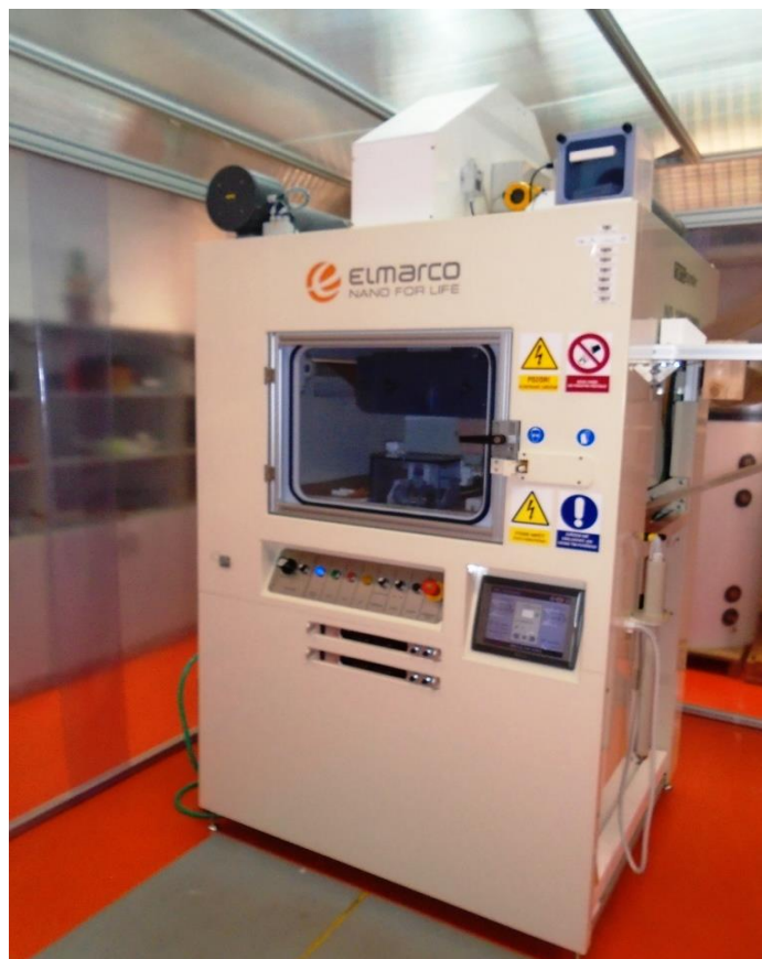
Obrázek 23: Zařízení pro elektrostatické zvláknování - Nanospider NS
