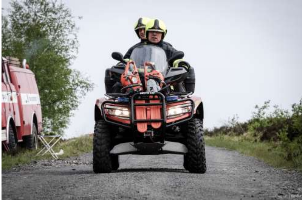
Obr. 27: Hasičská čtyřkolka vybavená vysokotlakým hasicím zařízením Zdroj: HZS Plzeňského kraje
