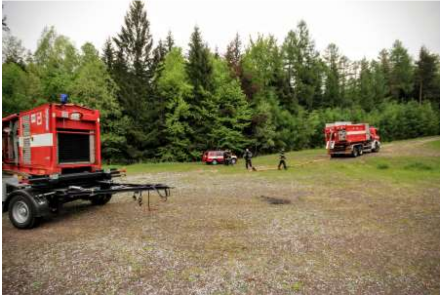
Obr. 32: Nasazení čerpadel Somati HFS Zdroj: HZS Plzeňského kraje
