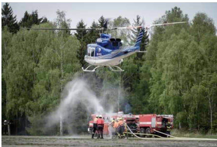
Obr. 30: Plnění bambivaku v podvěsu policejního vrtulníku Zdroj: HZS ČR Plzeňského kraje
