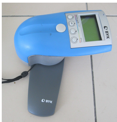
Obr. 13 Spektrofotometr – Spektro-guide 45/0 gloss (Culka – vlastní foto 2016).
