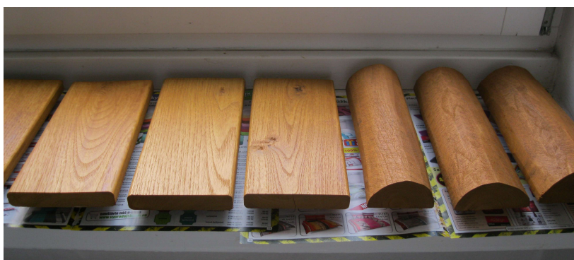
Obr. 3 Zkušební rovinné a tvarové vzorky v průběhu zasychání nátěrové hmoty, odstín hnědá (Culka – vlastní foto 2016).
