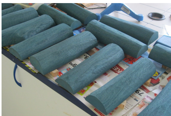
Obr. 4 Zkušební tvarové vzorky v průběhu zasychání nátěrové hmoty, odstín tyrkysová (Culka – vlastní foto 2016).
