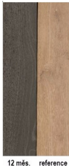
Obr. 1 Degradace dřeva akátu po jednom roce vystavení atmosférickým podmínkám (DŘEVO&stavby 2017).
