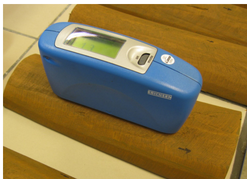
Obr. 12 Přístroj Erichsen Picogloss 503 – leskoměr (Culka – vlastní foto 2016).
