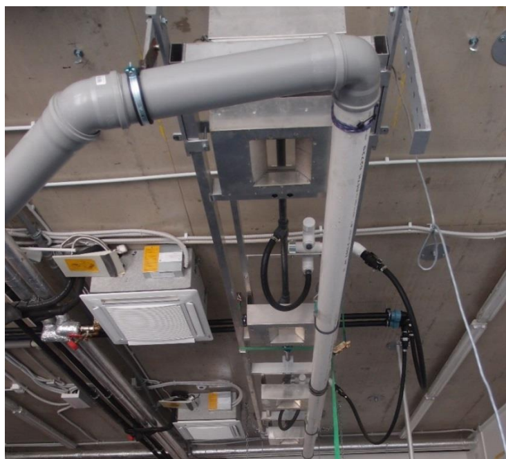
Obr. 12: Univerzitní dešťový simulátor Norton Ladder Rainfall Simulator (autor: Lucie Vávrová)
