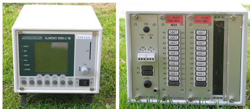
Obr. 12 Měřicí ústředna ALMEMO 5990 (archiv autora)
