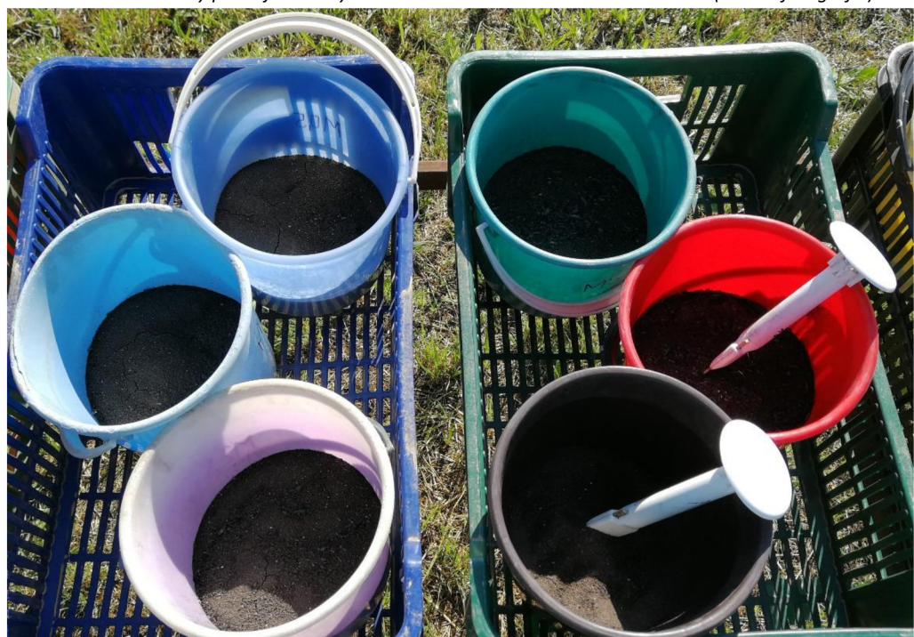
Obrázek 6 - Systém TMS4, který měří v kontrolním vzorku a ve vzorku s největším množstvím biocharu vlhkost a teplotu každých 15 min. (vlastní fotografie)
