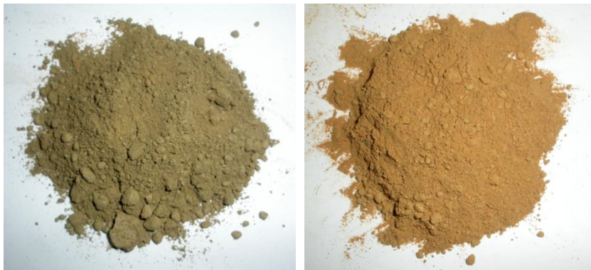
Obr. č. 22.: Vápenaté zemina (vlevo) a nevápenatá zemina (vpravo)
