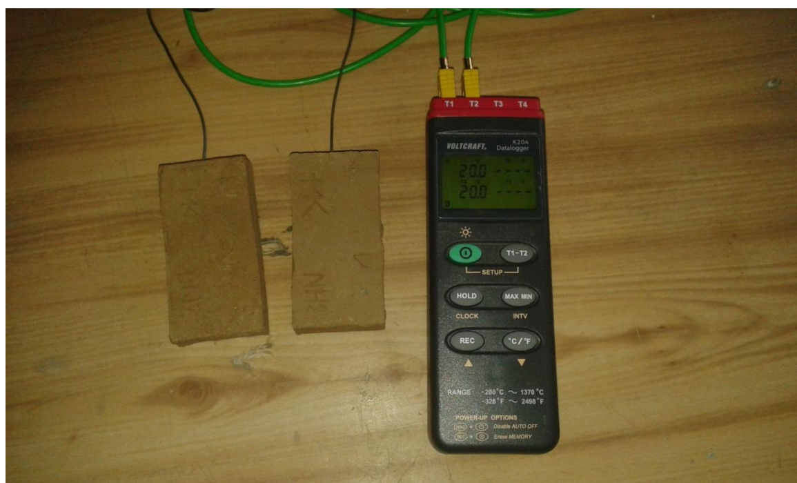
Obr. č. 21.: Analogový teploměr K204 s termočláneky zabudovanými uvnitř cihliček
