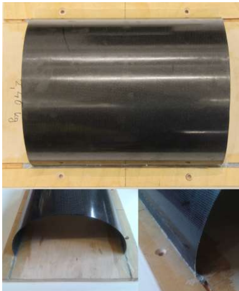
Obr. 5.2 Vyrobené vzorky dutin pro pádovou zkoušku.
