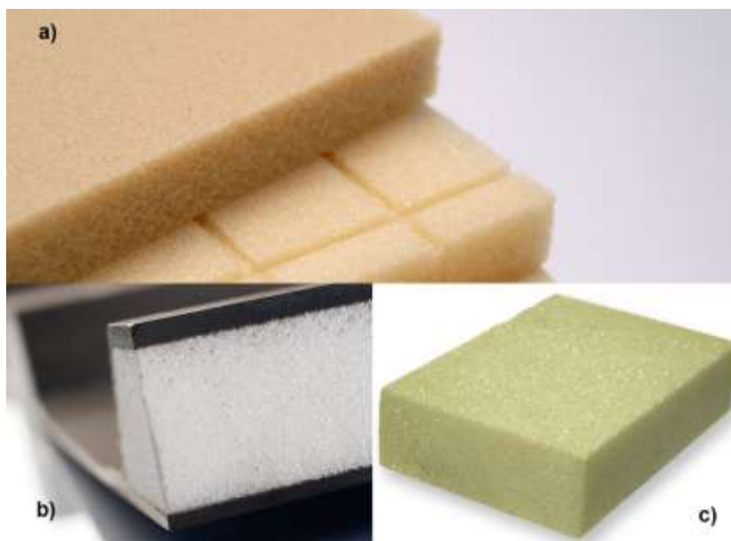
Obr. 3.10 Příklady konstrukčních pěnových materiálů – a) SAN, b) PMI, c) PVC [40], [41], [42].
