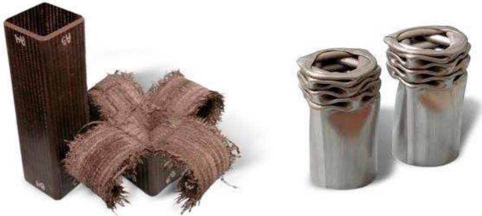
Obr. 3.15 Porovnání kompozitního prvku (vlevo) s kovovým (vpravo) po dynamickém zatížení.
