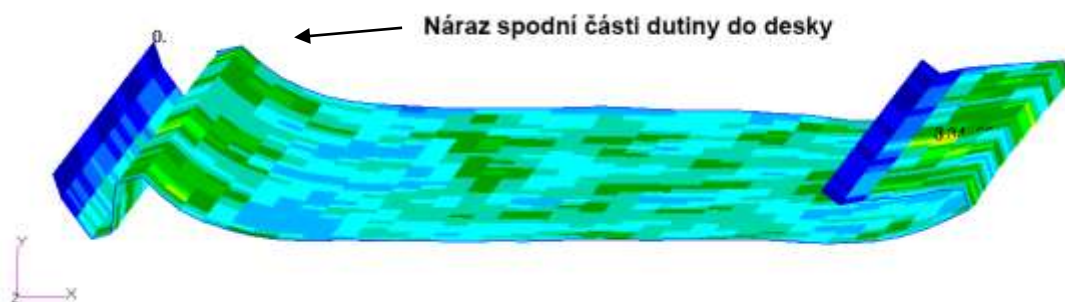
Obr. 6.6 Náraz deformovaného materiálu do desky odpovídá poslednímu růstu křivky síly.
