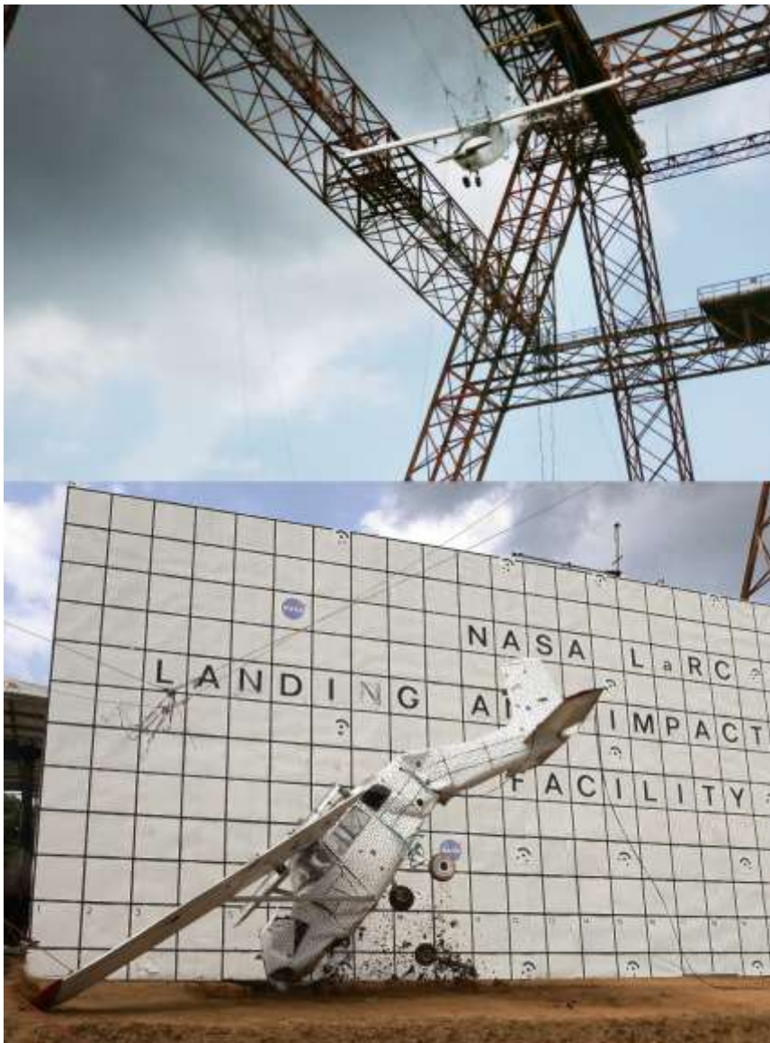
Obr. 2.6 Pádová zkouška celého letounu v NASA LaRC [16].
