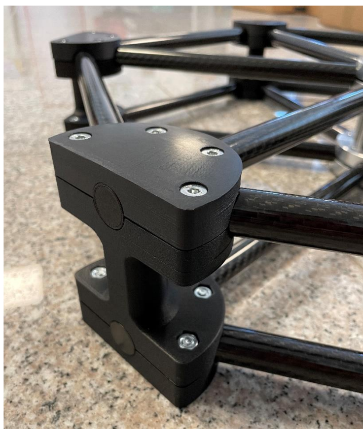
(6) Detail obvodového spoje
