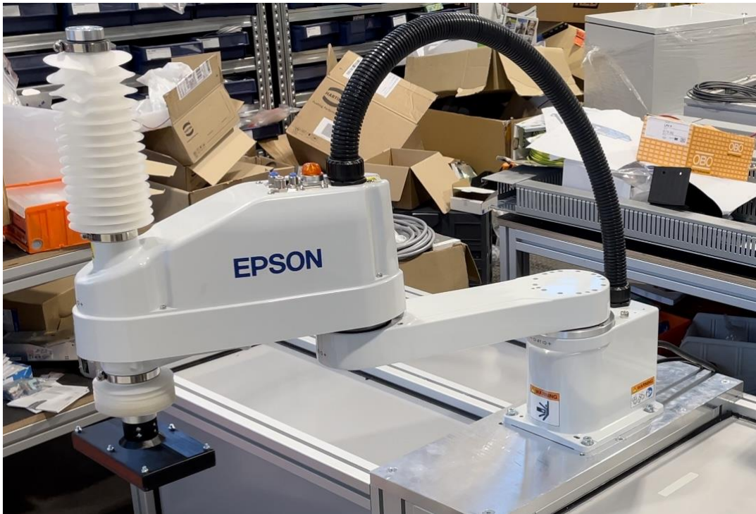
(1) Test provozního zatížení robota
