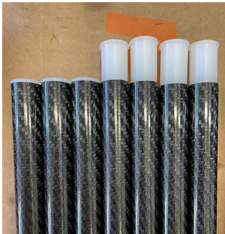
(5) Vtloukání silonových kolíků [17]
