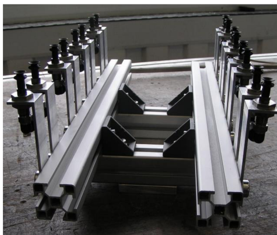
Obrázek 3:1 Konstrukce z hliníkových profilů Minitec
