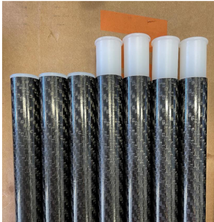
(5) Vtloukání silonových kolíku [17]
