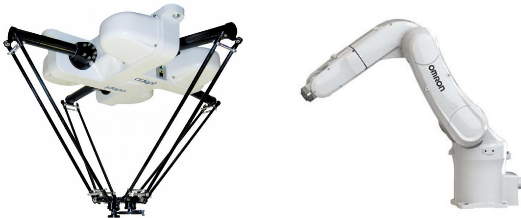
Obrázek 3 - Paralelní struktura (vlevo) a sériová struktura (vpravo) [3]
