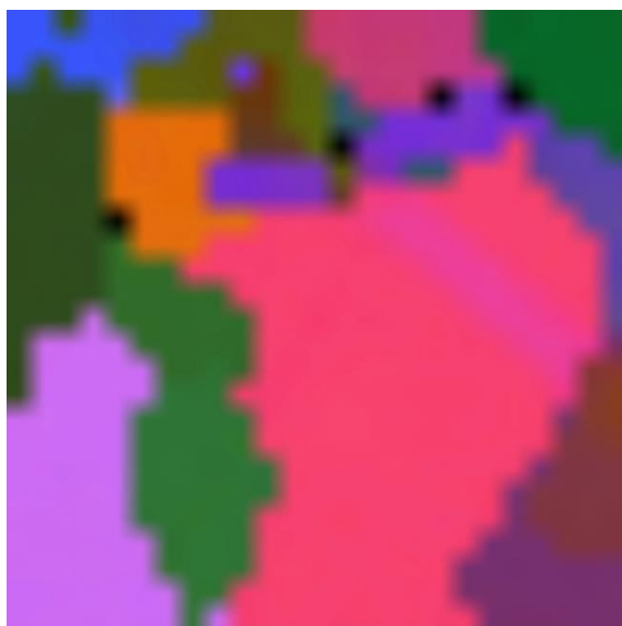
Obr. 31: Krytalografická mapa vzorku č. 3 s rozlišením mapy 25 x 25 px (2 x 2)
