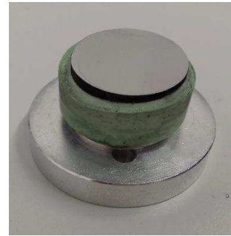
Obr. 30: Vzorek přilepený k diskovému terčiku
