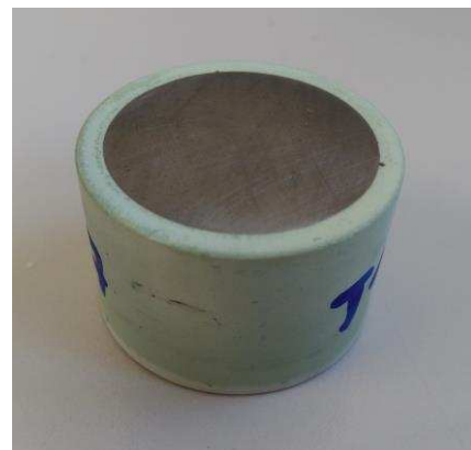
Obr. 16: Zalévací hmota po vytvrzení
