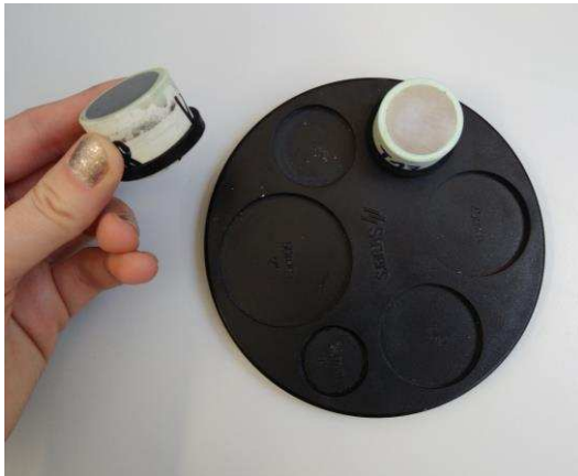
Obr. 17: Vyrovňovací nástroj pro nastavení fixačních kroužků na jednotlivých vzorcích
