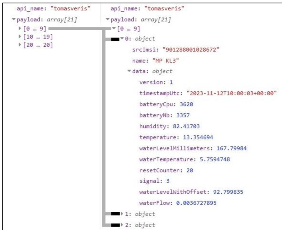
Obrázek 12 - náhled na příchozí záznamy zařízení v rámci jedné NodeRED zprávy; Zdroj: vlastní
