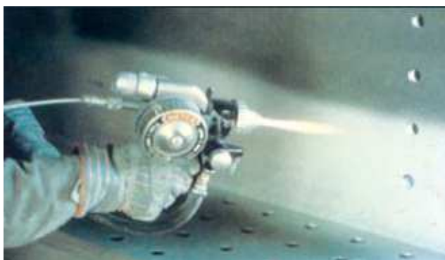
Obr. 41 Žárové stříkání zinku [32]
