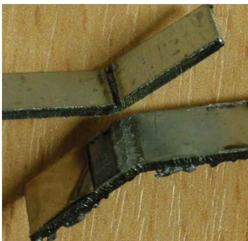
Obr. 53 Vzorek 9 po tahové zkoušce boční pohled
