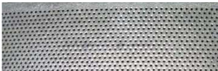
Obr. 12 Disk pro výrobu skelných vláken, průměr díry 0,58 mm [35]
