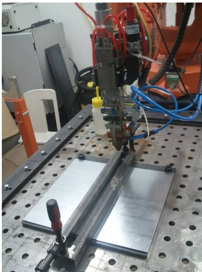
Obr. 42 Upnutí překládaných pozinkovaných plechů pomocí přípravku
