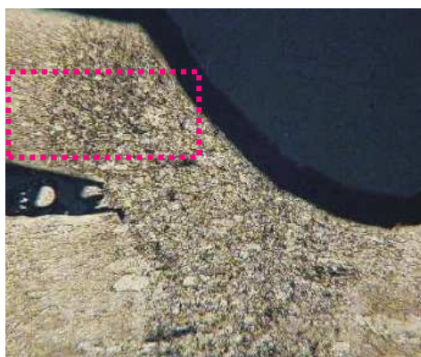
Obr. 34 Laserový svar zvětšeno 50x [30]
