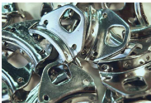
Obr. 39 Alkalicky zinkované součástky v nekyanidové lázni [51]
