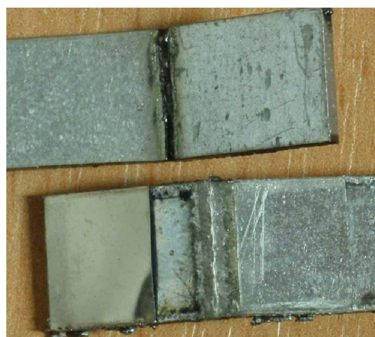
Obr. 54 Vzorek 9 po tahové zkoušce horní pohled
