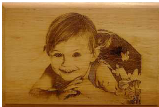
Obr. 13 Laserem gravírovaný obrázek [8]
