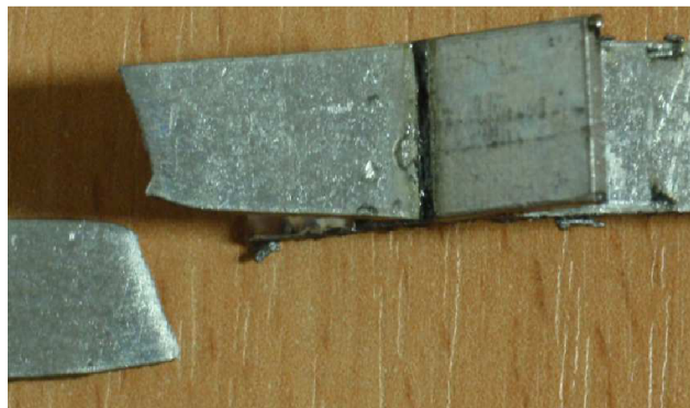
Obr. 56 Vzorek 10 po tahové zkoušce horní pohled
