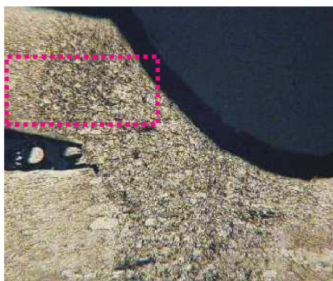
Obr. 34 Laserový svar zvětšeno 50x [30]
