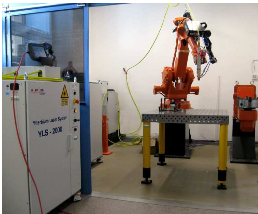
Obr. 43 Vlákňový laser a průmyslový robot [26]
