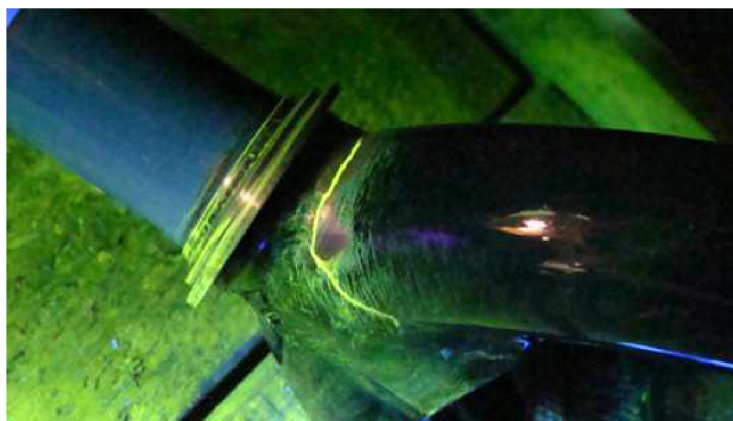
Obr. 26 Magnetická prášková zkouška s použitím UV lampy [28]
