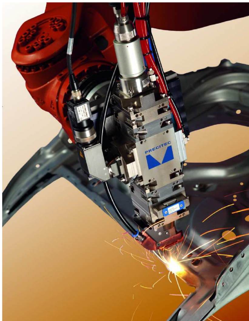
Obr. 1 Laserové svařování automobilových dveří [23]
