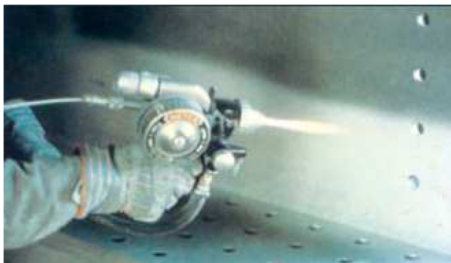
Obr. 41 Žárové stříkání zinku [32]
