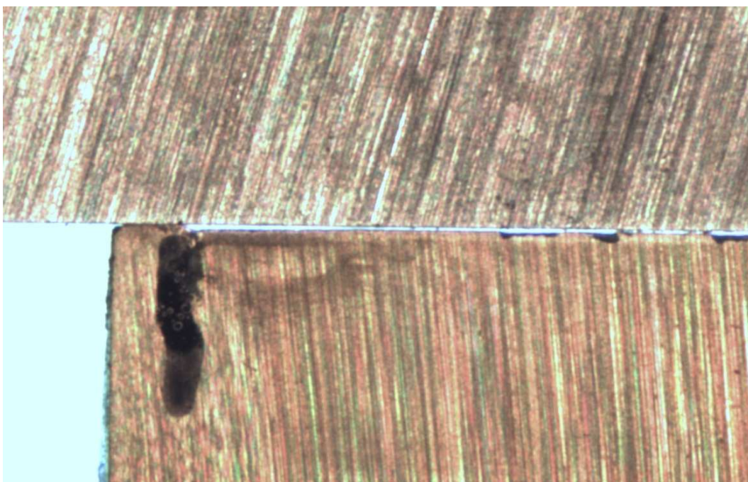
Obr. 25. Nůž TN1 - otupení po 2000m (Alena Krafová)
