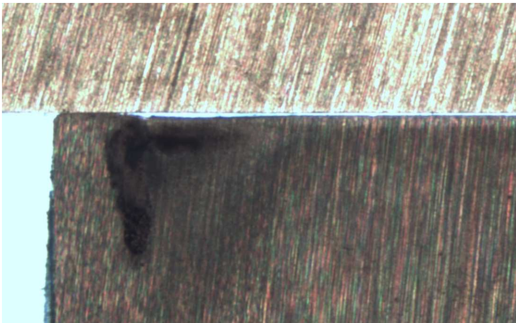
Obr. 25. Nůž TN1 - otupení po 2000m (Alena Krafová)
