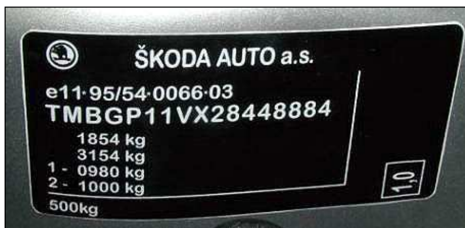
Obrázek 20: Padělaný typový štítek [22]
