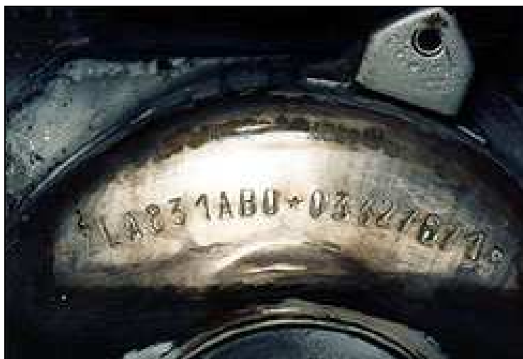
Obrázek 16: Ukázka padělaného VIN [20]
