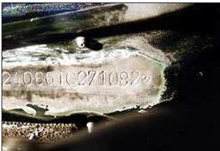
Obrázek 17: Přeražené znaky ve VIN [20]
