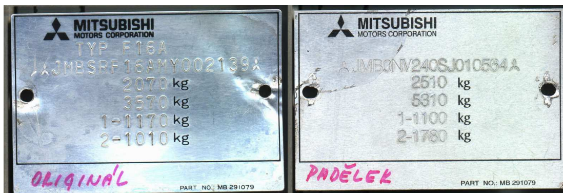
Obrázek 19: Padělaný plechový typový štítek [22]
