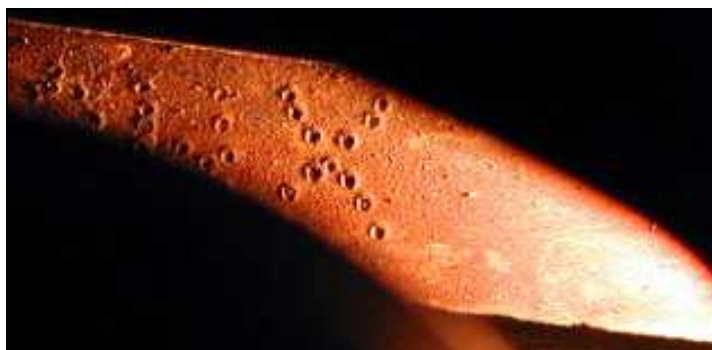
Obrázek 18: Část padělaného označení motoru [21]
